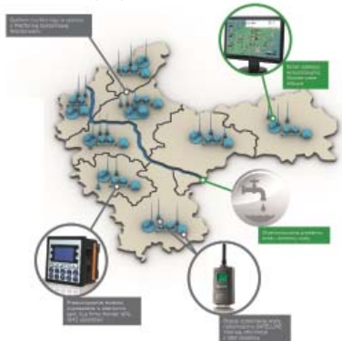
Rozproszony system monitoringu sieci wodno-kanalizacyjnej w dorzeczu Parsęty z wykorzystaniem radiomodemów SATEL
